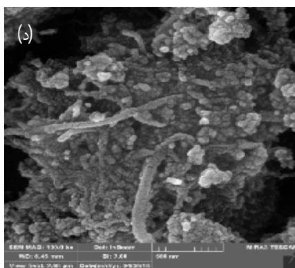
شکل 4. تصویر FESEM از MWCNT/SiO 2 (الف)، نمونه S1 (ب)، نمونه S2 (ج) و نمونه S3 (د).
