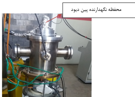
شکل 3. محفظه نگهدارنده پین دیود و اتصالات نگهدارنده پرتو ایکس نرم بر روی پلاسمای کانونی
